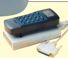
HHP-2000-DL, 红外下载盒和数据链接, 图片小于实际尺寸。
