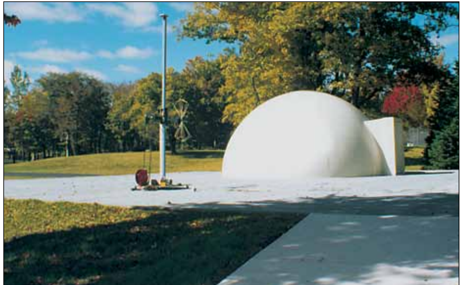
开阔测试场地(O.A.T.S.)，用于进行3米和10米测试。F.C.C.列名并获得NVLAP认可。
