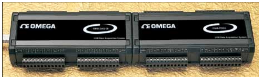
OMB-DAQ-56与OMB-PDQ2简单地插接在一起，即可获得额外通道容量。
